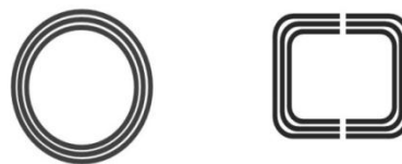
Slika 152: Lamelirano toroidno jedro in jedro, sestavljeno iz C-jeder
