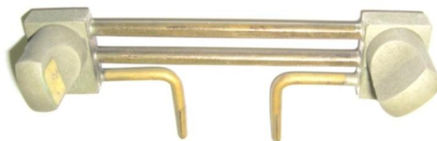
Slika 42: Soupor z opisom sponk (levo) in soupor za razširitev območja ampermetra (desno)
