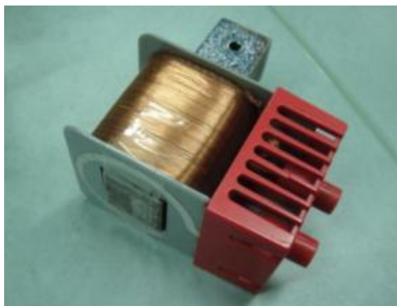
Slika 4.4: Izbrana tuljava ima 1600 zank in induktivnost 50mH.
