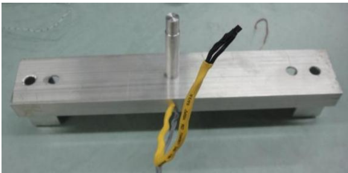
Slika 4.6: Ogrodje iz aluminija z izvrtinami za tuljave in Hallovo stikalo.
