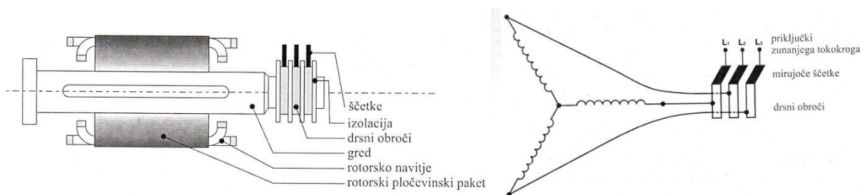
Slika 2.14: Levo: rotor z drsnimi obroči, desno: trifazno rotorsko navitje v vezavi Y [5].
