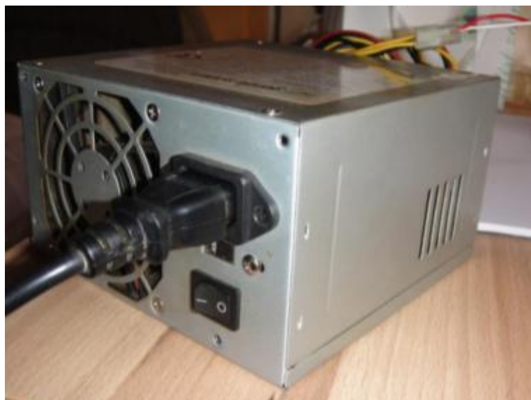
Slika 4.8: Napajalnik za računalnik je dober vir enosmerne napetosti in ima stikalo za vklop in izklop.
