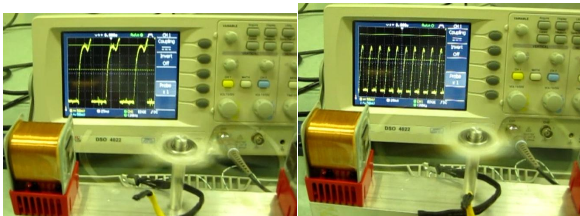
Slika 4.13: Opazujemo Hallovo stikalo (rumeno-črno na dnu slike). Desna slika ima manjšo frekvenco in je Hallovo stikalo odmaknjeno od sredine. Leva slika ima večjo frekvenco in je Hallovo stikalo na sredini.
