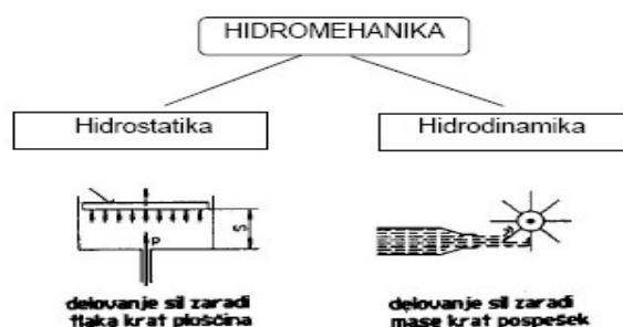
V hidravlični napravi energija potuje z gibanjem tekočine. Da bi lahko napravo dimenzionirali, moramo poznati osnovne zakonitosti gibanja tekočin ( hidrostatiko in hidrodinamiko ). Proces pretvorbe energije v hidravličnem sistemu predstavlja spremembo stanja tekočine, kar je prikazano na primeru. Hidravlična naprava je sestavljena iz naslednjih delov :
