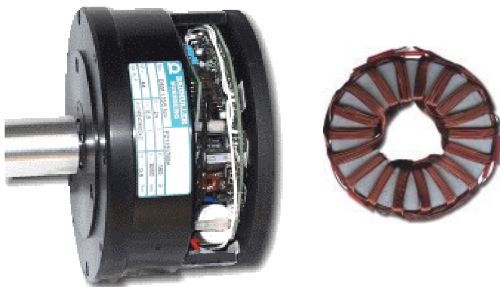
Slika 14: Izvedba enosmernega motorja brez ščetk brez utorov
