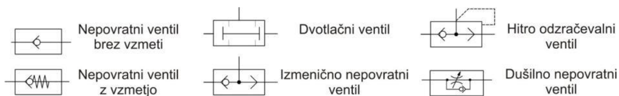
Slika 16: Simboli zapornih ventilov
