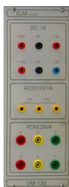
Slika 6: Stalni izvori enosmerne in izmenične napetosti Vir: Lasten
