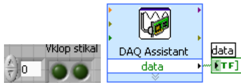
Slika 75: Prikaz na čelni plošči in blok diagramu pri digitalnem vhodu
