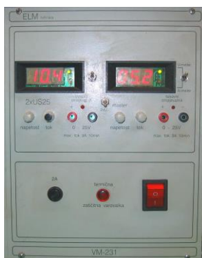
Slika 5: Nastavljiva stabilizirana izvora enosmerne napetosti Vir: Lasten
