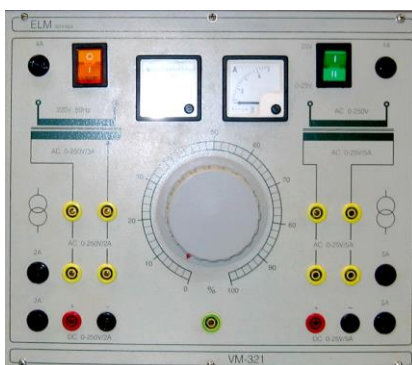
Slika 4: Nastavljiva izvora izmenične napetosti Vir: Lasten
