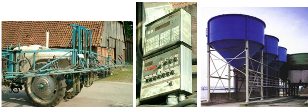
Slika: Elektronska regulacija v kmetijstvu, levo: škropilnica, v sredini : komandna plošča škropilnice, desno : tehtalna naprava v silosu.
