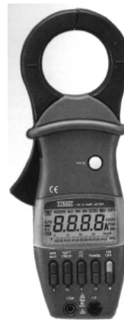
Levo: analizator moči, desno: tokovne klešče.
