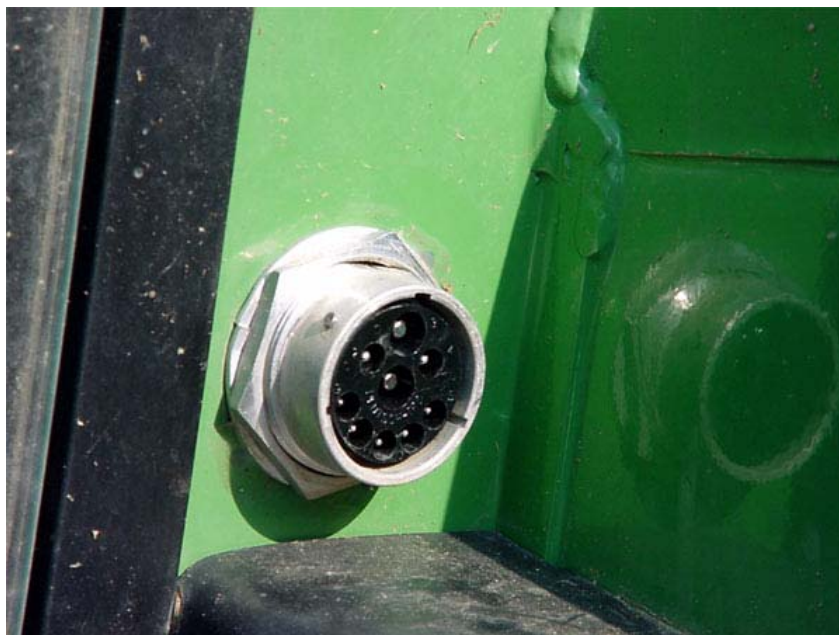
Slika: Isobus vtičnica, vidni so štirjeveliki priključki za napajanje porabnikov in pet podatkovnih priključkov.
