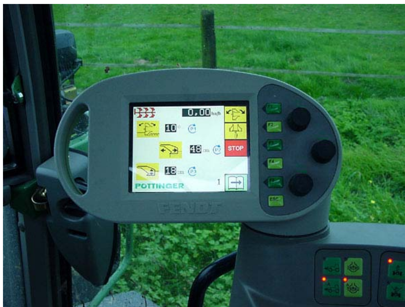
Slika: Isobus navidezni terminal (VT, virtual terminal).
