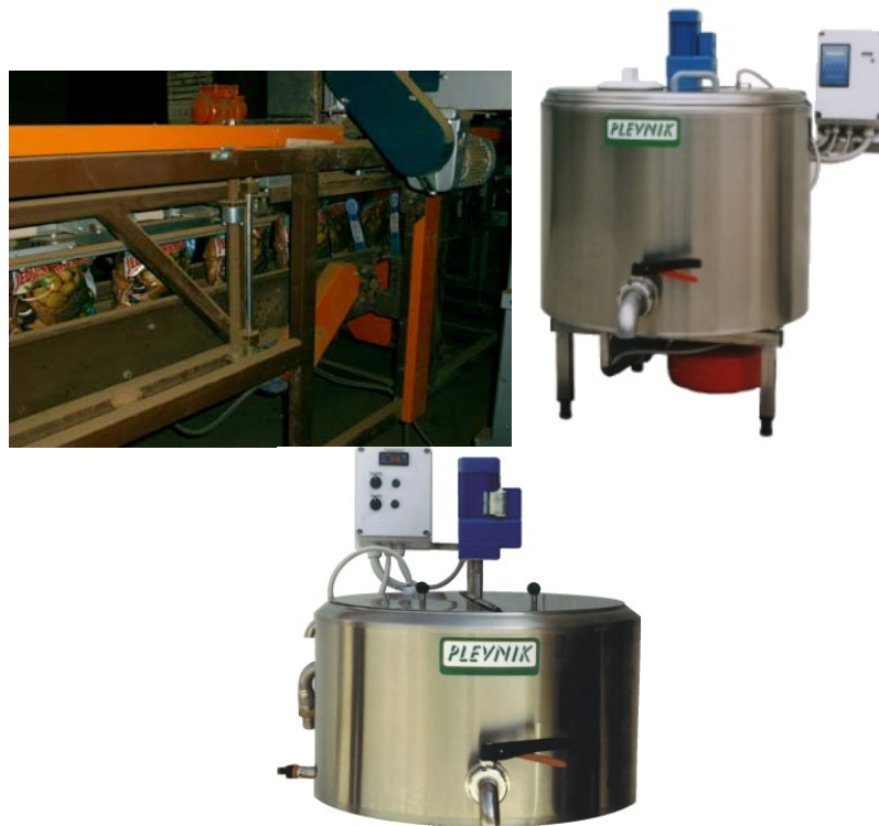
Slika: Elektronska regulacija v kmetijskopredelovalni industriji. Levo: linija za pakiranje krompirja, v sredini pasterizator, desno sirarski kotel.
