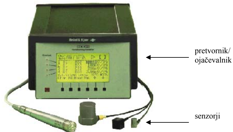
Slika : Klasični merilni sistem za merjenje vibracij
