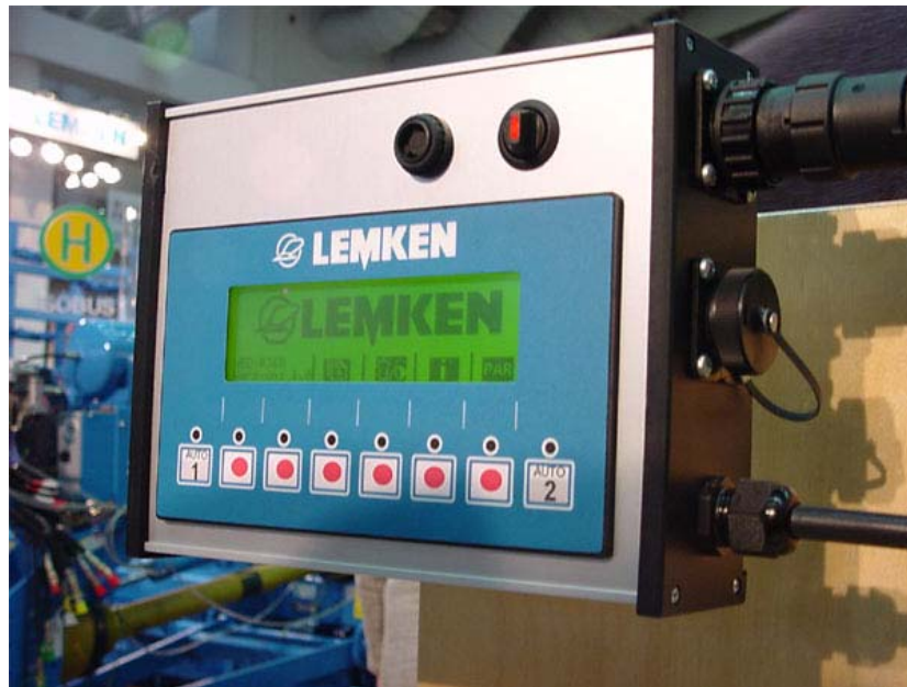
Slika: Terminal na priključku.
