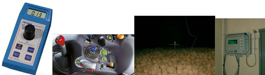
Slika : Merilnik fosfatov v vodi (levo, merjenje), upravljalne komande v traktorju (sredina levo, vodenje), regulacija temperature v skladišču krompirja (v sredini desno in desno, regulacija).
