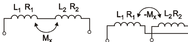
Slika 7-12: Princip določanja medsebojne induktivnosti M_X z merjenjem skupne induktivnosti.
