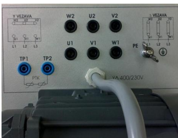
Slika 15: Priključki šolskega elektromotorja
