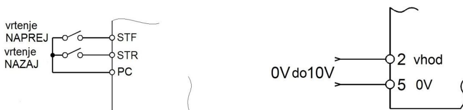
Slika 19: Upravljanje pretvornika s programirljivim krmilnikom
